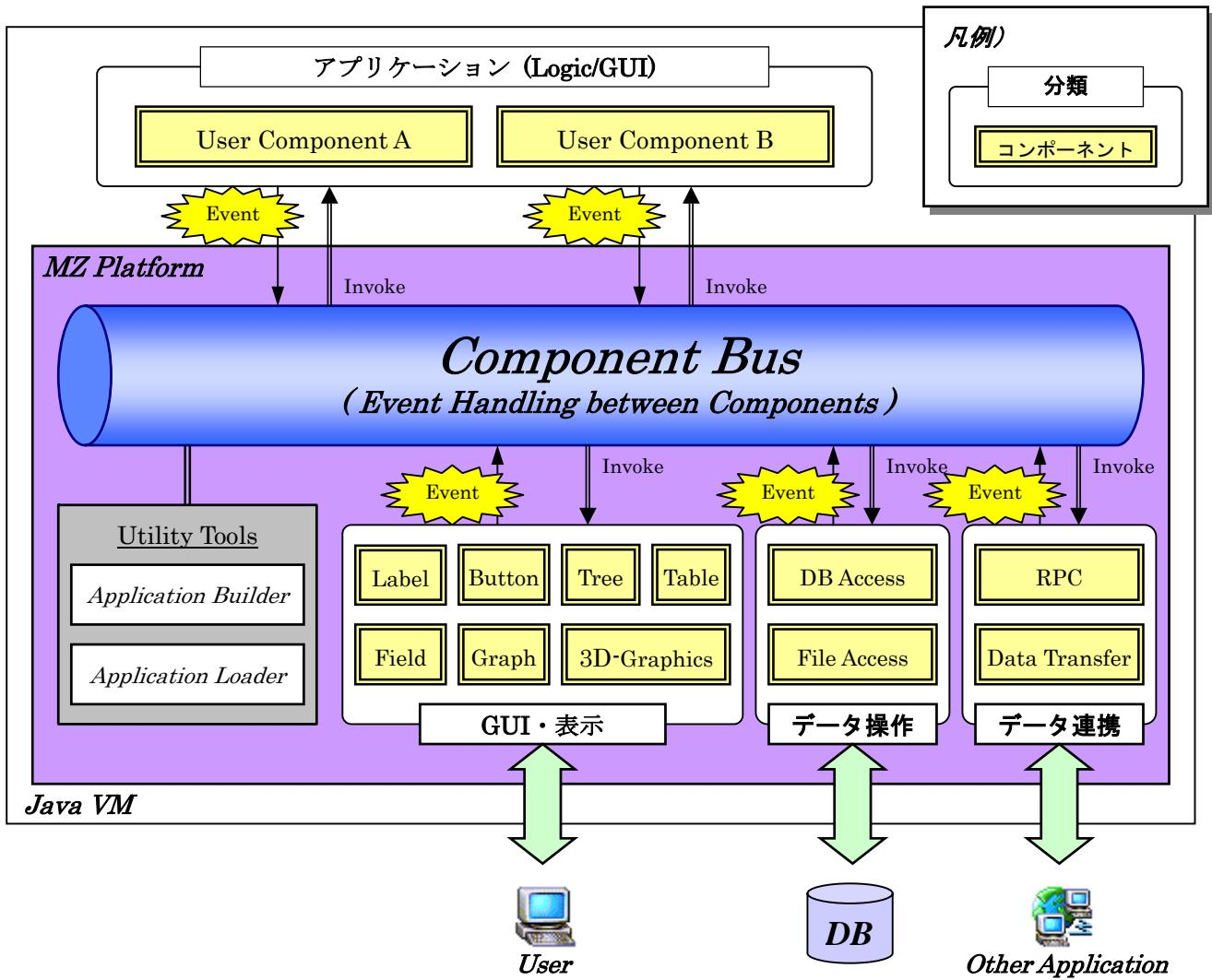
図 1 プラットフォーム基本構造
