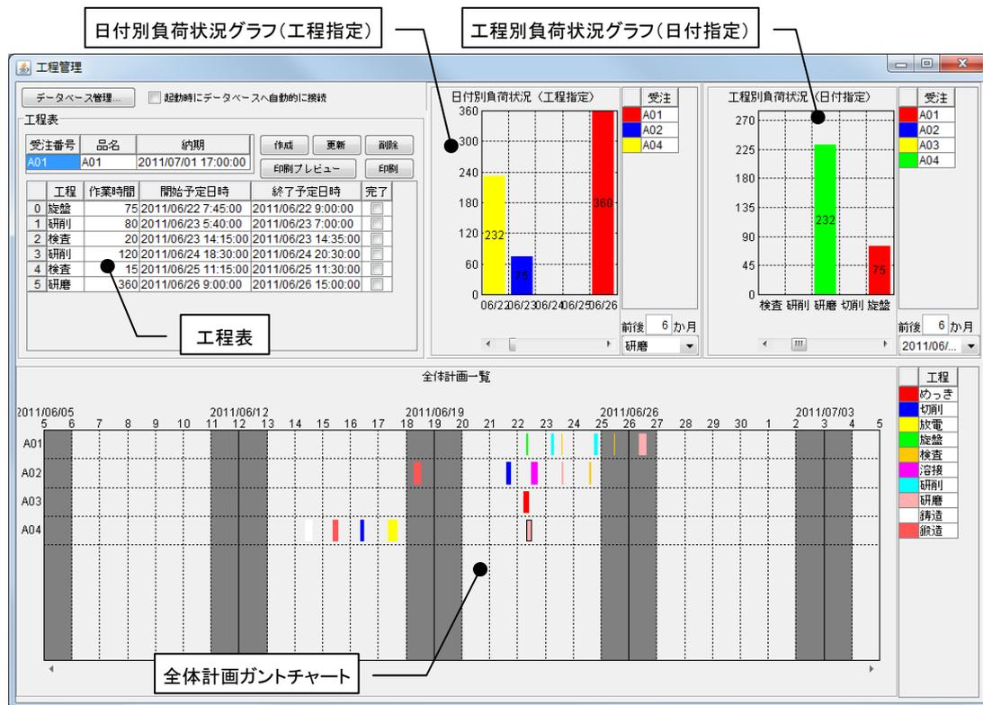
図 1 工程管理システム簡易版概観
