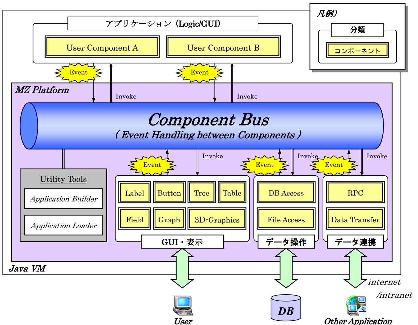
図1 プラットフォーム基本構造
