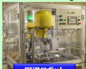
搬送ロボット
