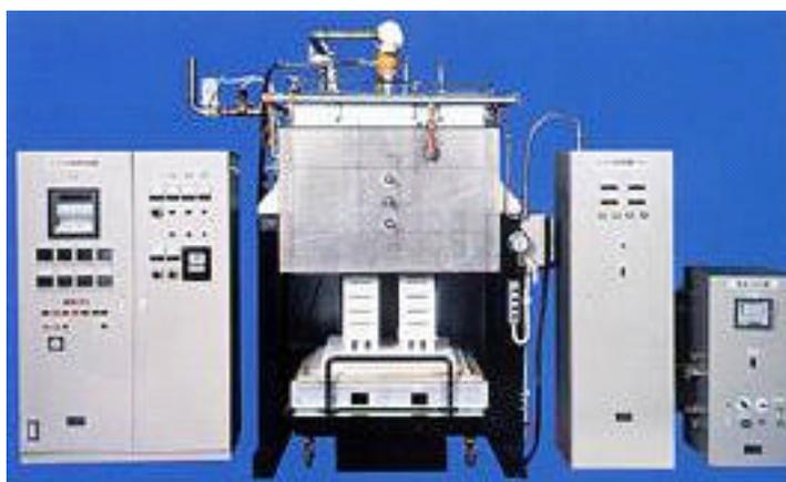
写真1 バッチ炉
