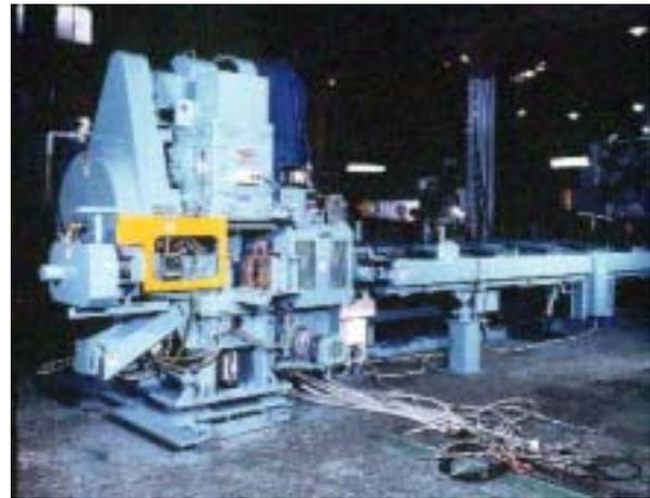
写真2 超精密切断方式ピレットシャー
