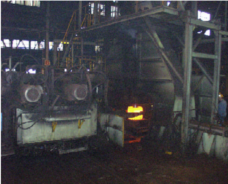
写真3.3.1-1 マニピュレータを使ってハンマによる鍛造作業
